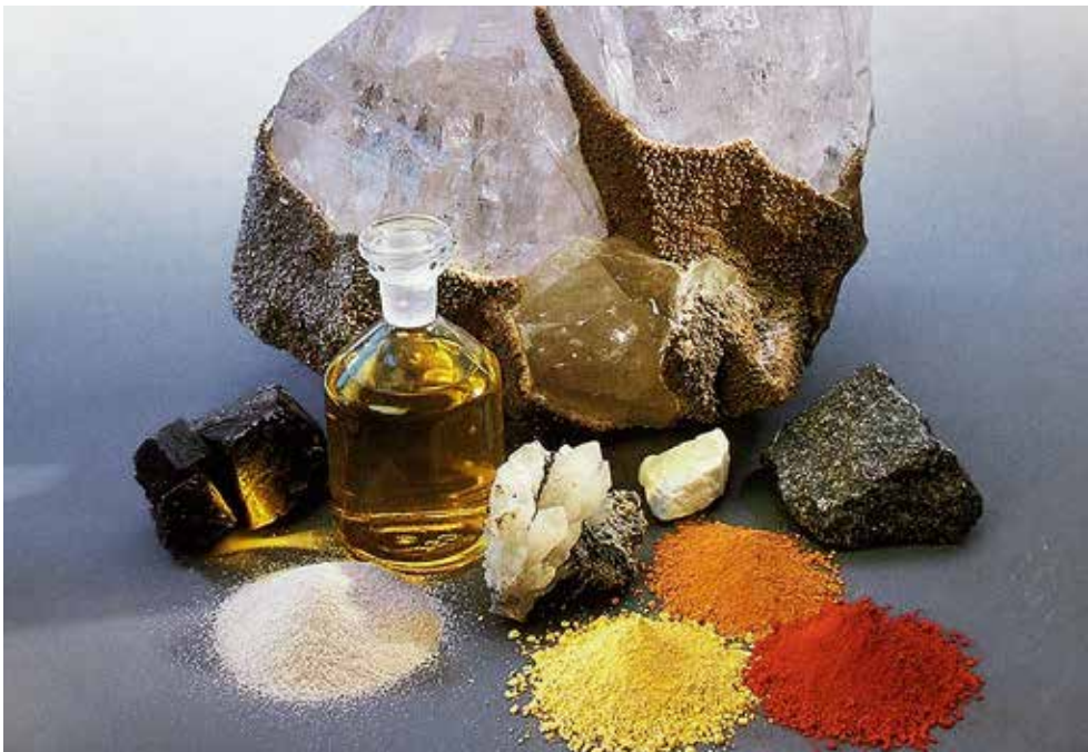
Hauptbestandteile einer Silikatfarbe: Bindemittel Wasserglas oder Sol-Silikat, anorganische Pigmente, mineralische Füllstoffe
