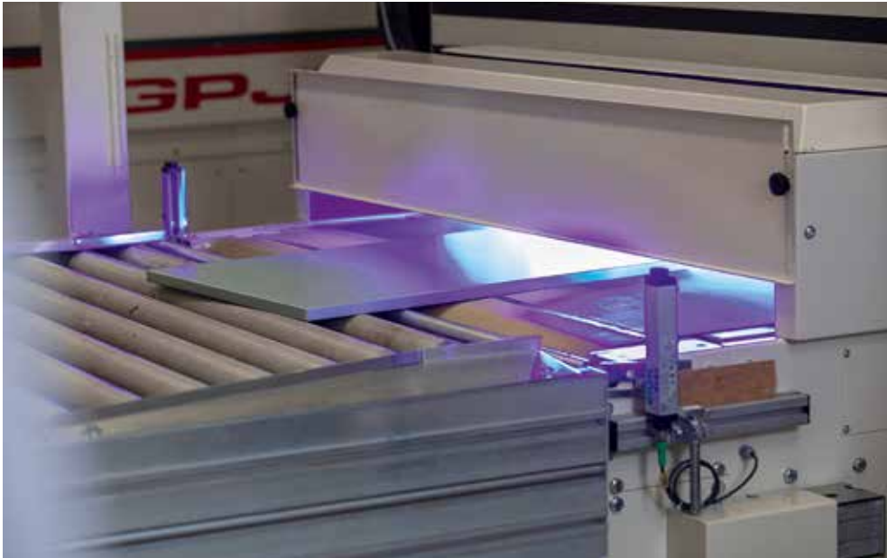
Effiziente Härtung von Lacken mittels ultraviolettem Licht
