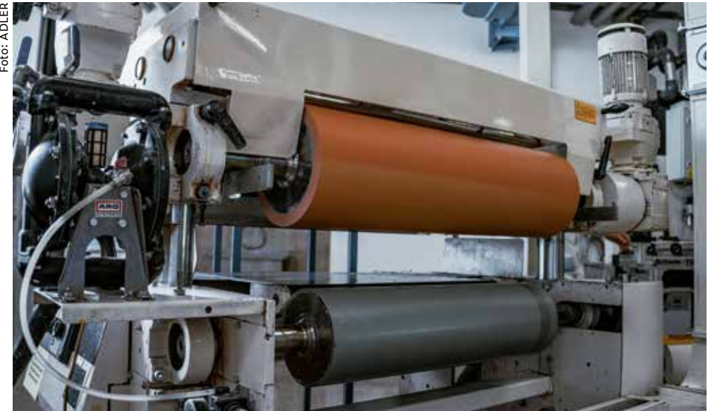
Die Walzlackierung ist ideal für ebene Oberflächen.
