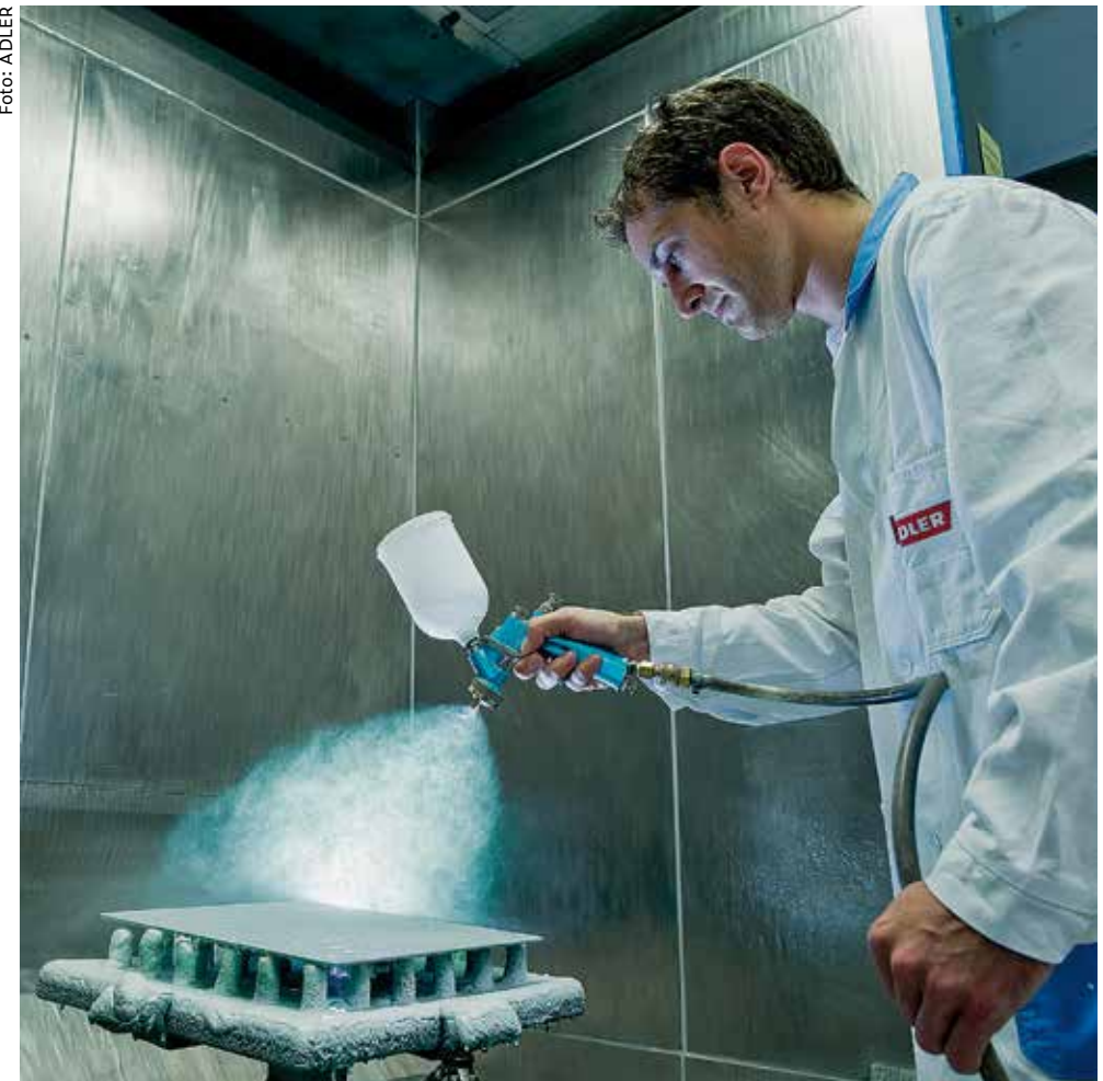
Die durch Lack berieselte Rückwand bindet den Sprühnebel direkt in Lack ein.
